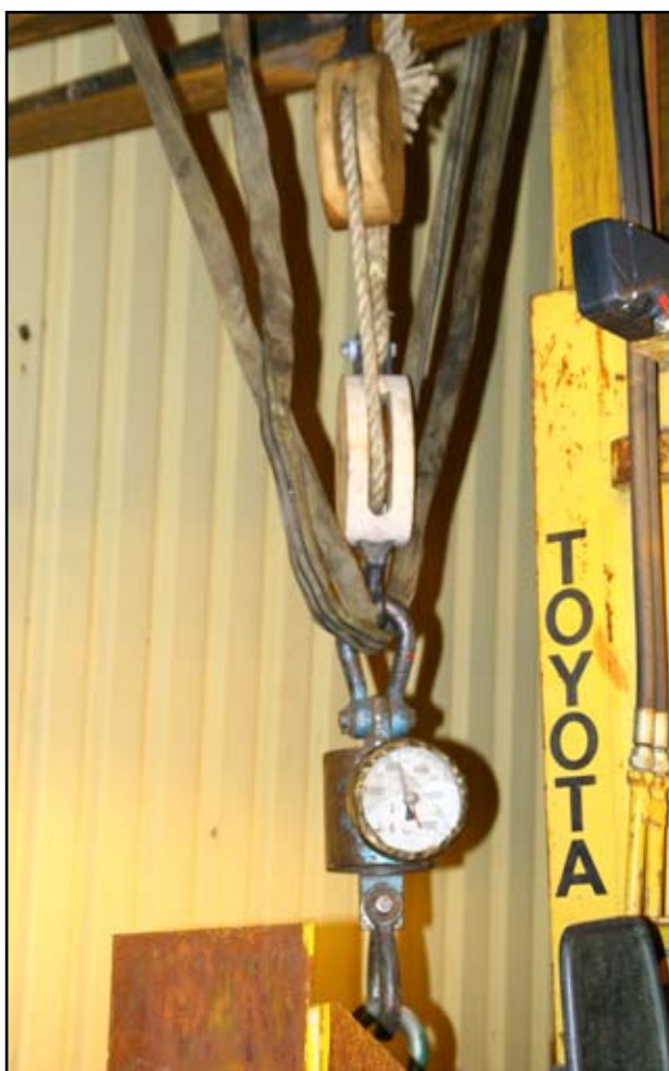
14: Utsnitt fra testoppsettet: Blokker og vekt.
