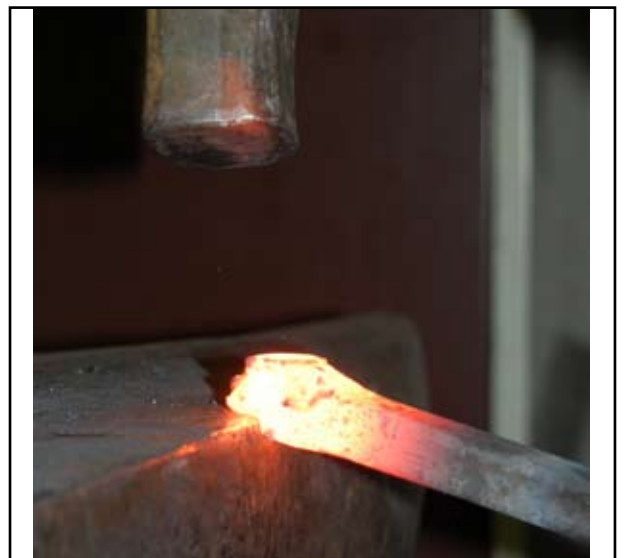
IV: Kanten på ambolten lager et hakk i "hodet".
