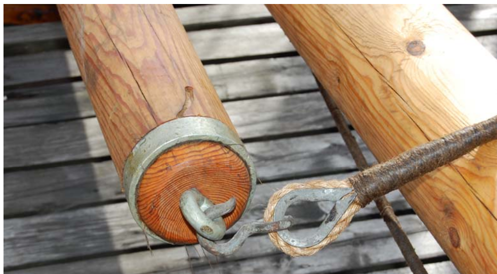
Essesveiste øyebolter er slått inn i endene av skverråa som feste for braser.
