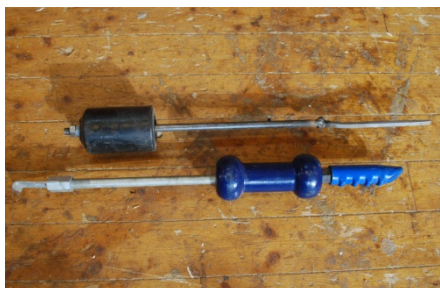
Bolttrekkere. Den ene sveises til boltens/spikerens hode, mens den andre griper tak under hodet på bolt/spikeren.
