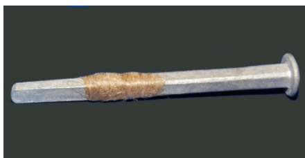
Her er drev surret omkring spikeren for å sikre at det blir god tetning mellom spiker og treverk. Drevet vil dra seg opp mot hodet når spikeren slås inn
