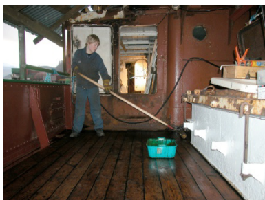
Hensiktsmessig redskap til oljing kan være rull på langt skaft og gode breie malekoster.
